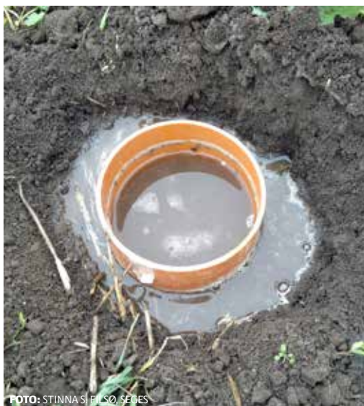
Infiltrationsmålinger i Jerslev.
